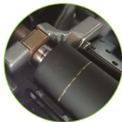
Witte lijn met slijtage die laat zien dat de aandrukrollen beginnen te verslijten.
